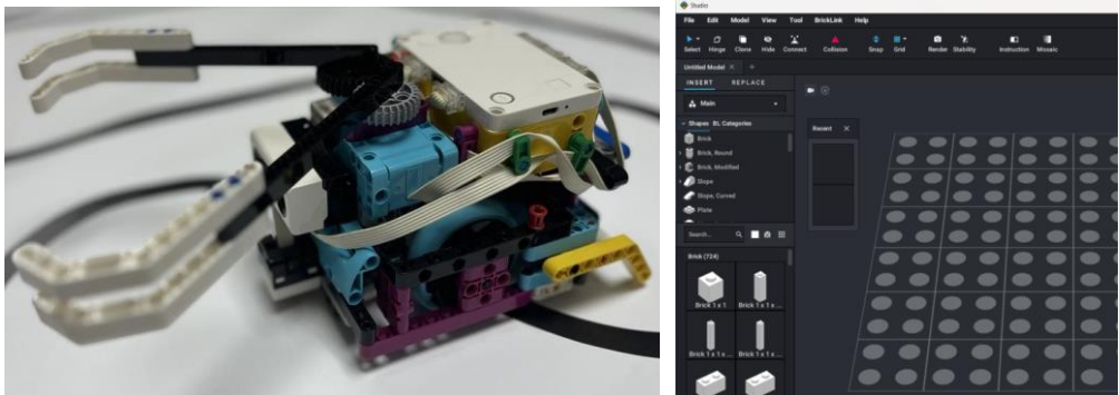
Σχήμα2: Σχεδίαση ρομπότ α) αριστερά η κατασκευή, β) δεξιά το λογισμικό
